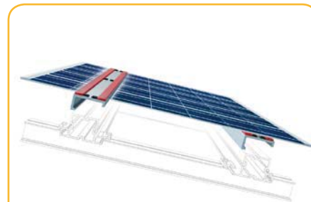
Montaža fotovoltaičnih modula
